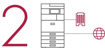
標準のネットワークポートに加え、オプションのプリントサーバーを装着することにより、もう1系統のLANに接続し印刷することができます。ネットワークごとに排紙先を分けて出力\*することも可能です。
