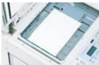
目盛りに合わせて原稿をセンターにセット
